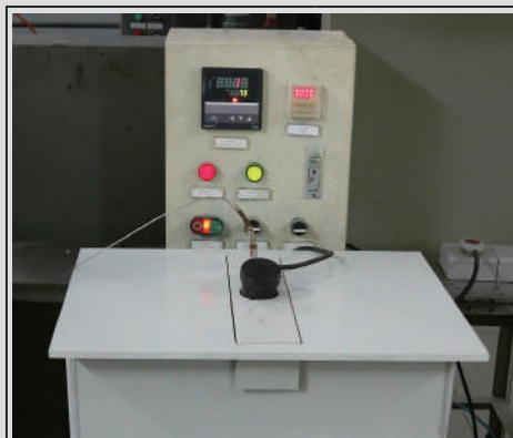
Bain de test à l'hypochlorite de soude
