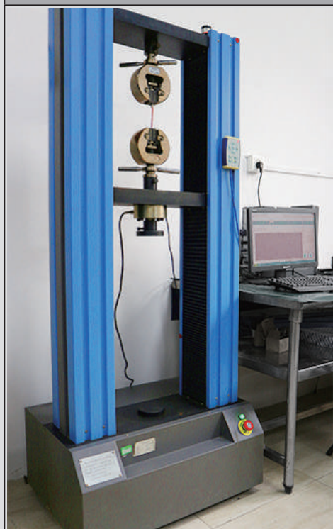
Machine d'essai de force d'arrachement
