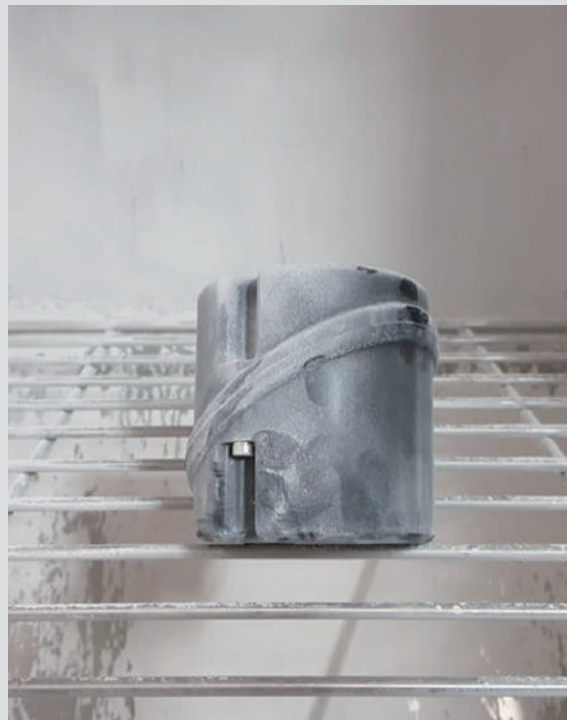
Boitier en cours d'essai IP6x
