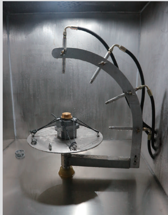
Boitier en cours d'essai IPx9K
