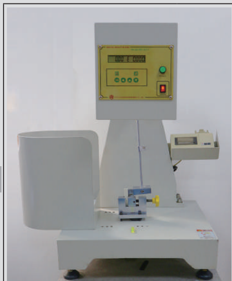
Machine d'essai Charpy
